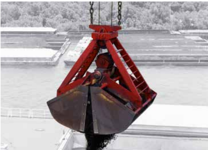
PEINER Vierseil-Zweischalen-Stangengreifer (VSG) beim Umschlag von Eisenerz PEINER Four-Rope Dual Scoop Grab (VSG) handling iron ore
