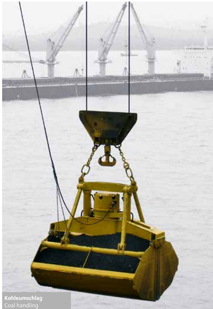
PEINER Motor-Zweischalengreifer (MZG/MZGL) beim Kohleumschlag PEINER Motor Dual Scoop Grabs (MZG/MZGL) handling coal
