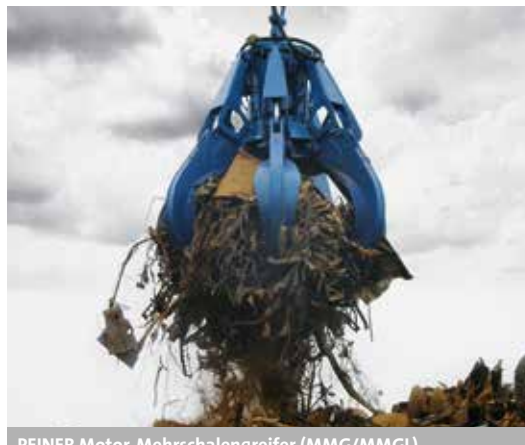
PEINER Motor-Mehrschalengreifer (MMG/MMGL) beim Umschlag von Schrott PEINER Motor Orange Peel Grab (MMG/MMGL) handling scrap
